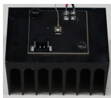
写真 9 フィン下向き (空気の流れを妨げた向き)
